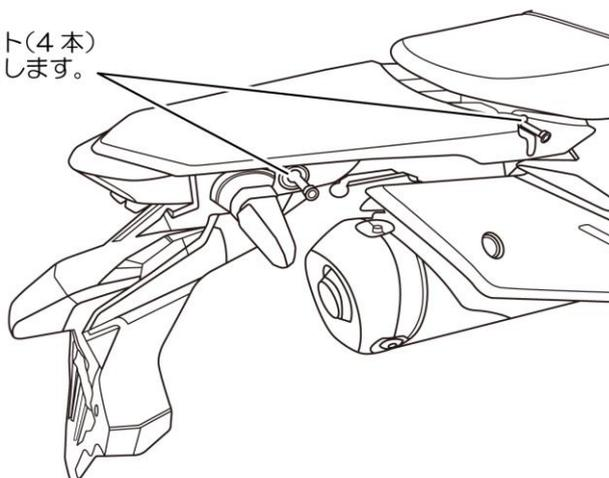
2. ①グラブバーキャリア前側取付け部を仮組みします。シート前方を差し込みした状態で、シート後方をわずかに持ち上げてシートとテールカウルの間にはキャリアの前方を滑り込ませてください。
