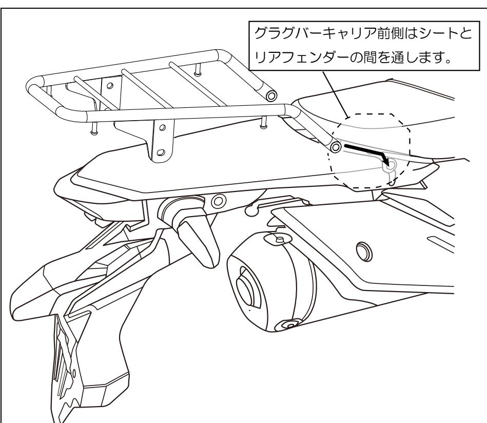
3. ①グラブバーキャリア本体の前方取り付け部を純正段付スペーサー、③ボタンボルト M8X65 (2ヶ) で仮組みします。の後方取り付け部を純正段付スペーサー、④ボタンボルト M8X40 (2ヶ) と②スペーサー (2ヶ) を使用して車体に仮留めします。
