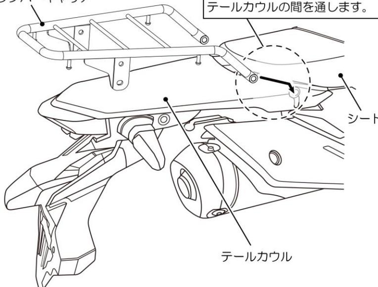
3. ①グラブバーキャリア本体の前方取り付け部を純正段付スペーサー、③ボタンボルト (M8X65) 2本で仮組みします。後方取り付け部を純正段付スペーサー、④ボタンボルト (M8X40) 2本と②スペーサー2個を使用して車体に仮留めします。
