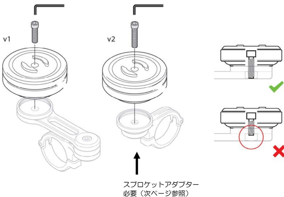
同梱されているスプロケットアダプターは、モトマウントプロのハンドルクランプにアームを使用しないで直接に取り付ける場合に使用してください。
