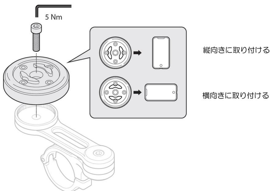
アーム使用の有無によりボルトを選択し、4mm六角レンチを使用して、正しい長さのボルトをマウントに深く締め付けてください。※指定締付トルク値は5 Nmです。
