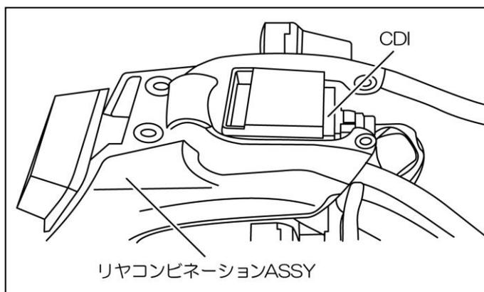
2. 車両のメインスイッチをOFFにして、純正CDIから配線をカプラー部分で外して純正CDIを取り外します。
