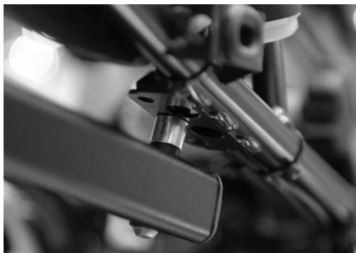
ボタンボルトをいったん抜いて スペーサを外します。サイドカバー、純正パニアレールの順に組み付け、ボタンボルトを締めます。スペーサは使用しない。
