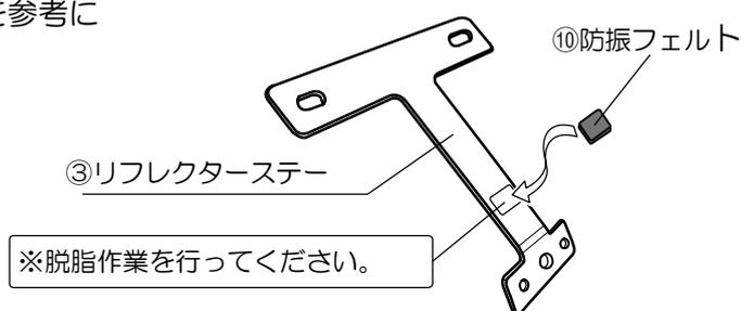
6. ①ナンバーベースに、ナンバープレート、③リフレクターステー、純正リアウインカーを取り付けます。
