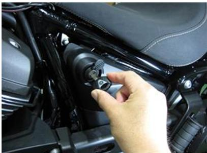
2. 純正シングルシートを取り外します。(純正ボルト 1 本を取り外します)
