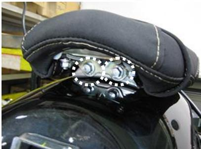
4. リアフェンダー上の 2 つのステーを取り外します。(純正ボルト計 4 本を外します)
