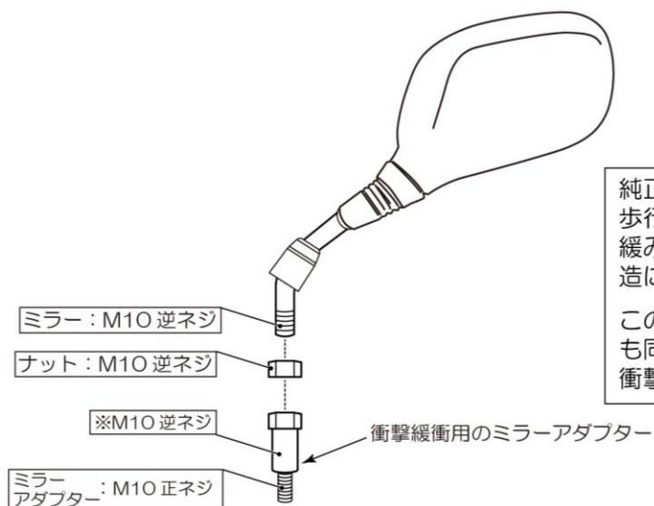
純正ミラーを逆ねじ、車体側を正ねじとすることで歩行者等に前から接触した際はアダプターボルトが緩み、後ろから接触した際はミラーが緩むような構造になっています。
