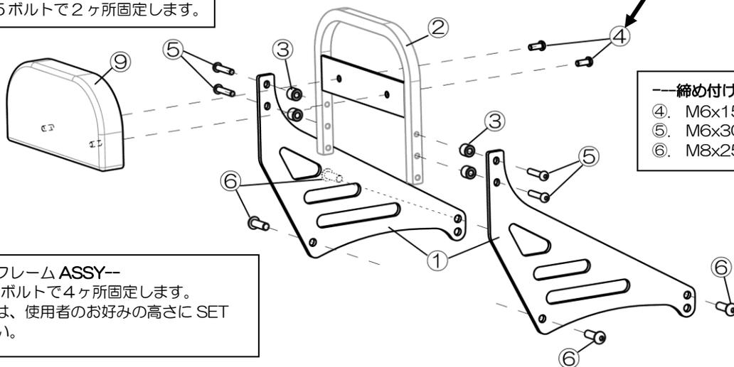
2. ①ベースプレートを⑥M8×25 ボルトで仮締めします。
