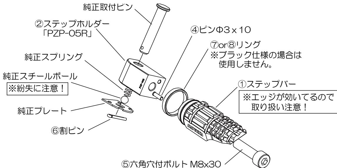
8. チェンジペダル側も同様の手順にて取り付けます。
