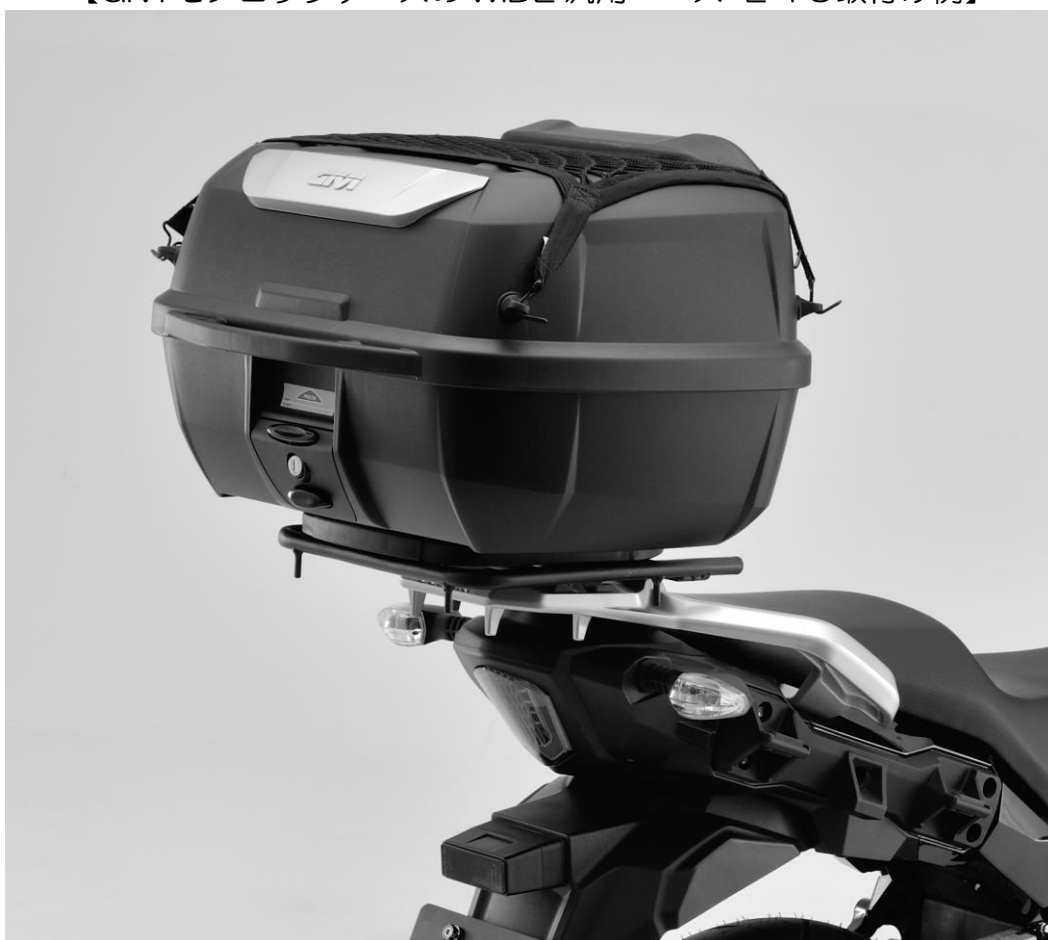
【GIVIモノロックケースのWIDE汎用ベース+E43取付け例】
