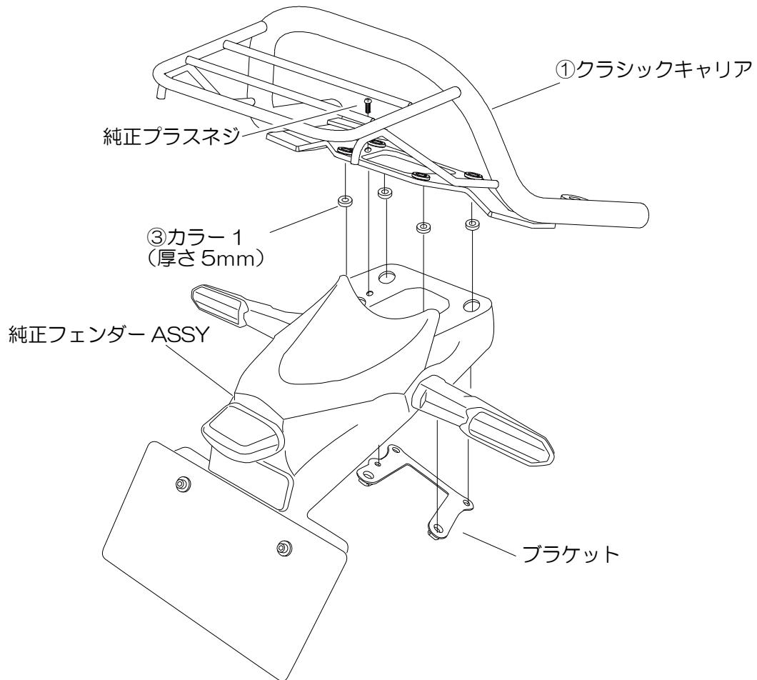
12. 手順11で組付けた①クラシックキャリアと純正フェンダーASSYを車体に合わせ手順9で取り外した純正ボルトM8X25(4本)で車体に仮固定します。
