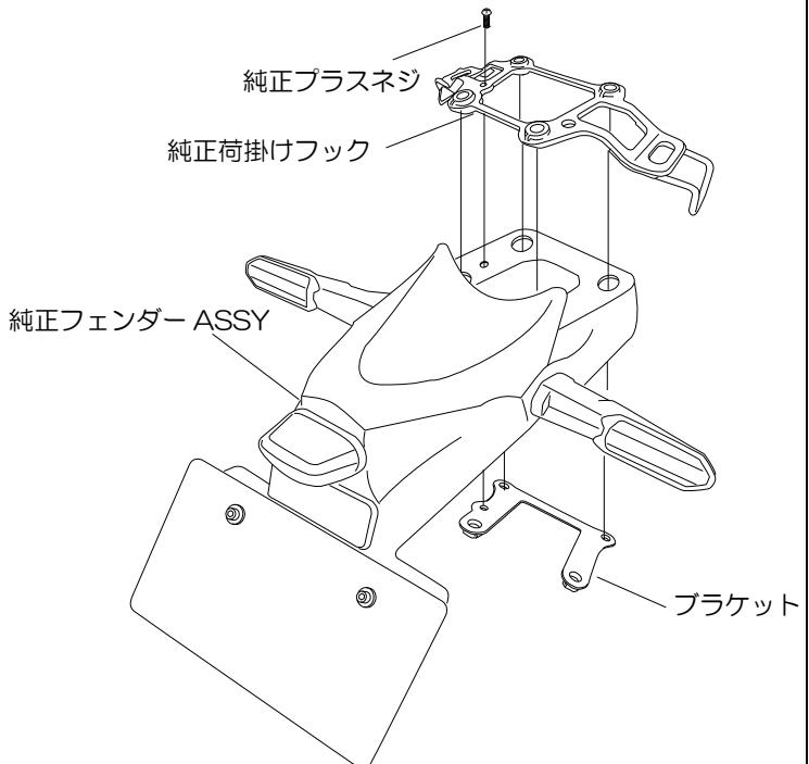
11. ①クラシックキャリアと③カラー1（4個）を使って手順10で取り外した純正プラスねじ（M5）を使用して純正フェンダーASSYを組付けます。③カラー1は純正フェンダーの穴に入れます。
