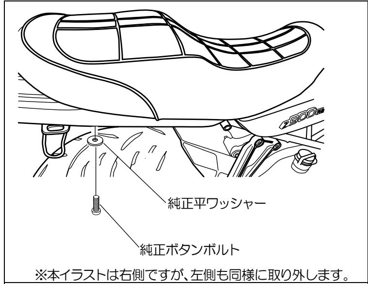
2. リアフェンダー裏側のキーシリンダーを回して純正シートを外します。
